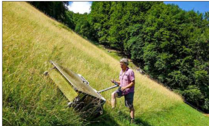
Der eBeetle ist weltweit der einzige steilhangtaugliche Saatguternter. (Bild: zvg)
